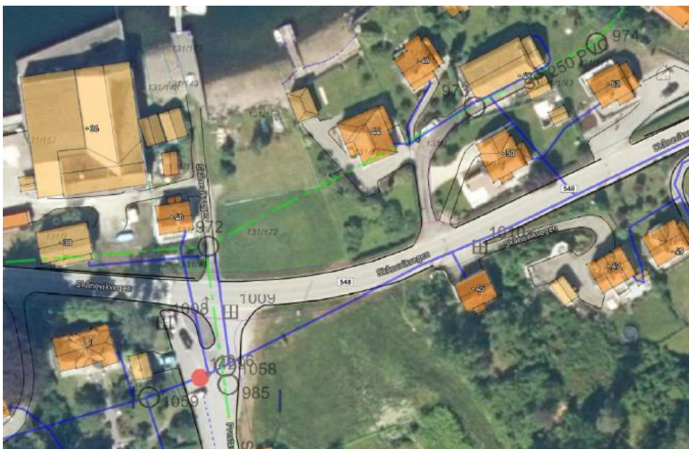
Figur 5 - Avlaupsleidning (grøn) som går over tomta. Blå leidning syner eksisterande vassleidning. (kjelde: tilsendt frå Etne kommune)
